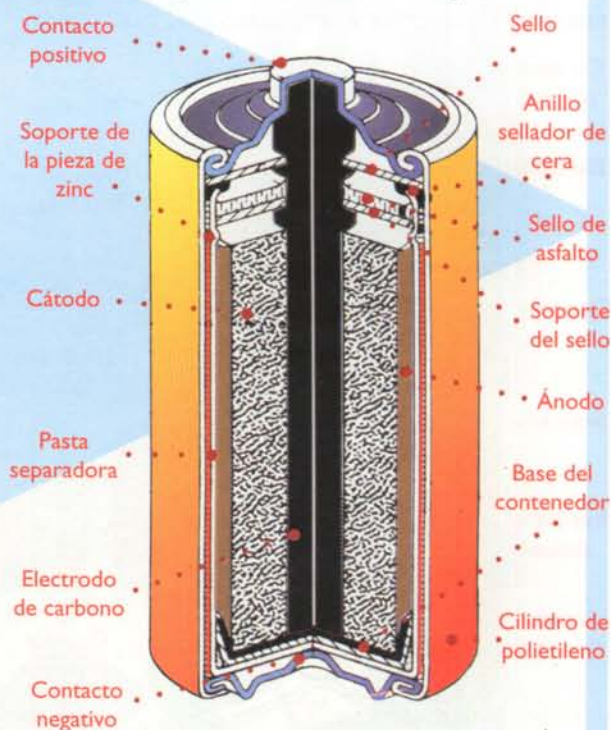
Figura 5.5. Estructura interna de una pila de carbón-zinc.
